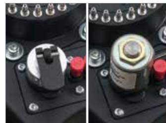
2 冲刷装置 冲刷装置冲洗针织元件。分机械式和电控式两种。
