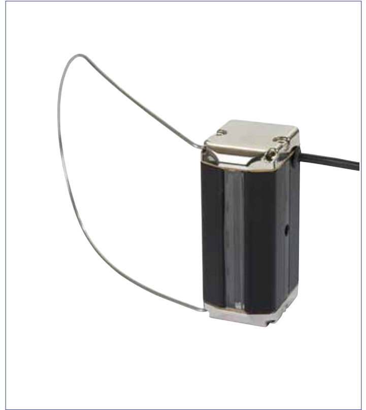
扫描头 扫描头轻靠在织物表面。用反射光监测疵点。自带光源以一定斜角照到织物上在反回到扫描头上。
